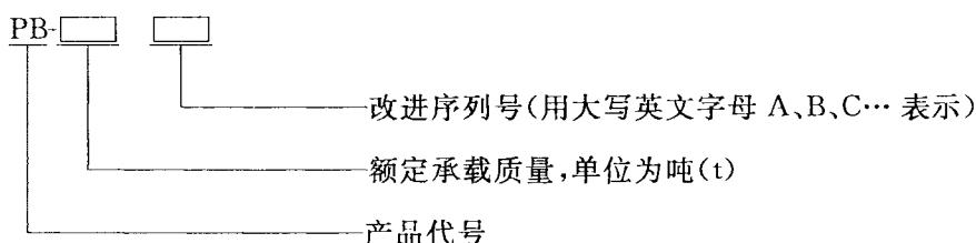
示例：额定承载质量为 10 t，第二次改进型平板式制动检验台，其型号表示为 PB-10B。
