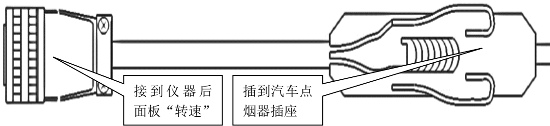
图 4.19 点烟器测量转速
